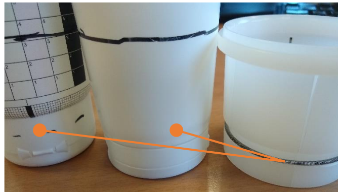
(IZQ) Ajuste sobre tapón, en tubo estándar (CEN) Ajuste sobre falda, en tubo con tapón reducido
